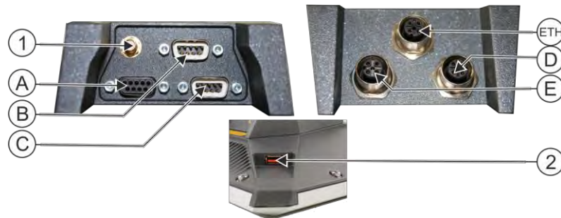
Aperçu des raccordements
