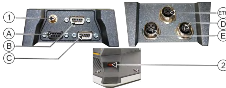
Panoramica dei connettori
