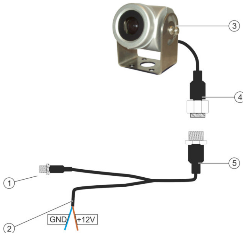
Telecamera con cablaggi
