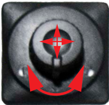
Abb. 46. Schalter elektrische Spiegelverstellung Dachkonsole
