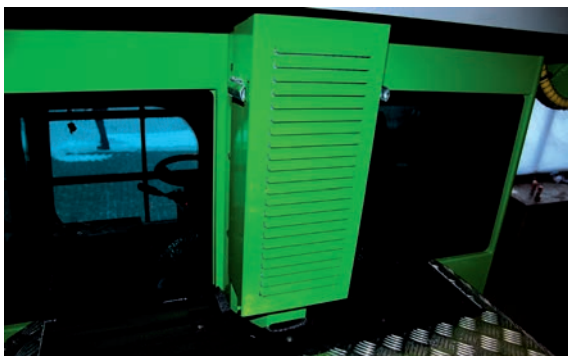
Abb. 202. Filtereinheit Verschlussdeckel öffnen.
