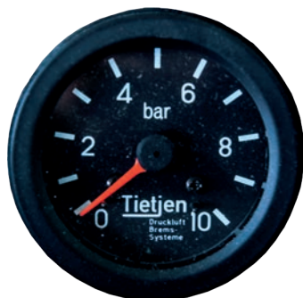
Abb. 57. Manometer Druckluftanlage DAMMANN-trac
