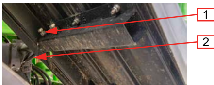
Abb. 169. Kotflügel links hinten entfernen
