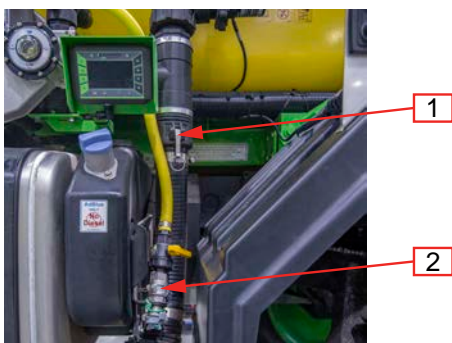
Abb. 160. Verlängerung Saugschlauch lösen
