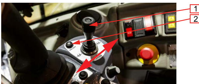
Abb. 144. Mit Kreuzschalthebel Klappung entlasten
