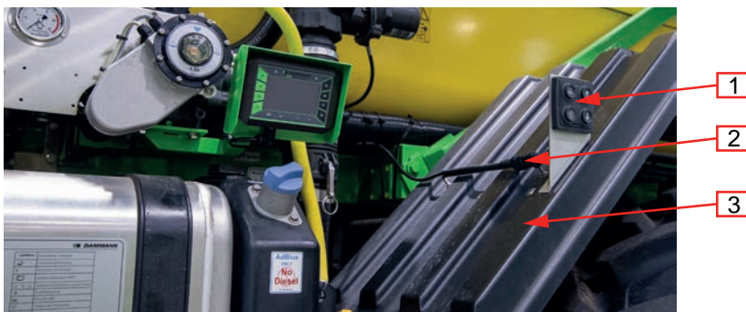
Abb. 154. Steckverbindung von Kotflügel lösen
