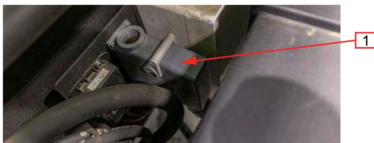
Abb. 165. Stecker Fahreug - Gerät lösen
