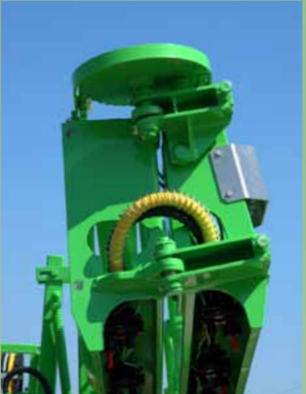
De nieuwe spuitboomconstructie zorgt voor een langere levensduur en onderscheid zich door een optimale bescherming van de meervoudige doppenhouders en zorgt voor een betere stabiliteit. Ook geschikt voor vloeibare bemesting met kunstmestdoppen.
