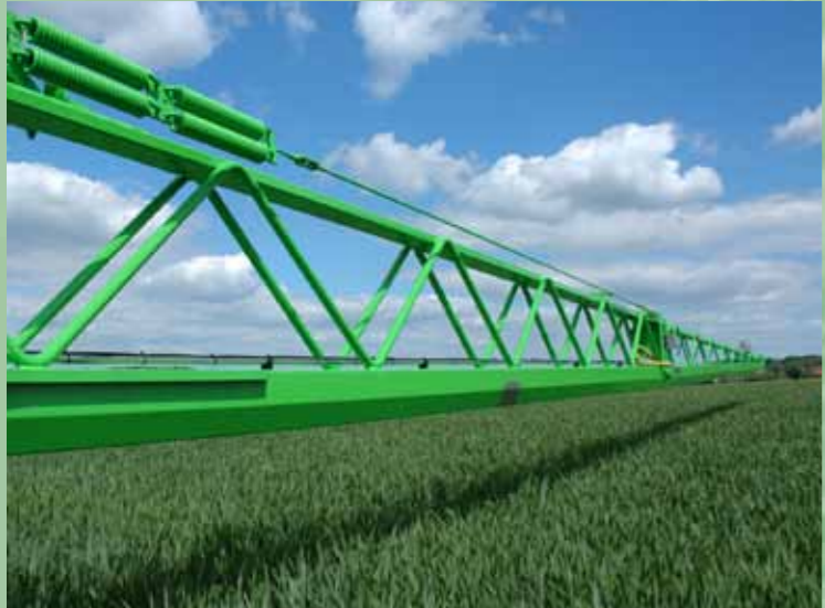
De nieuwe spuitboomconstructie zorgt voor een langere levensduur en onderscheid zich door een optimale bescherming van de meervoudige doppenhouders en zorgt voor een betere stabiliteit. Ook geschikt voor vloeibare bemesting met kunstmestdoppen.
