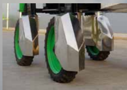
beschermkap - voor het sparen van het gewas (Optie).
