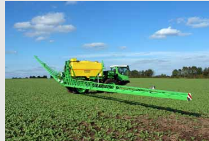
Spuitboom correctie voor optimale hoogteaanpassing in heuvelgebied
