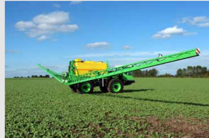
Spuitboom correctie voor optimale hoogteaanpassing in heuvelgebied
